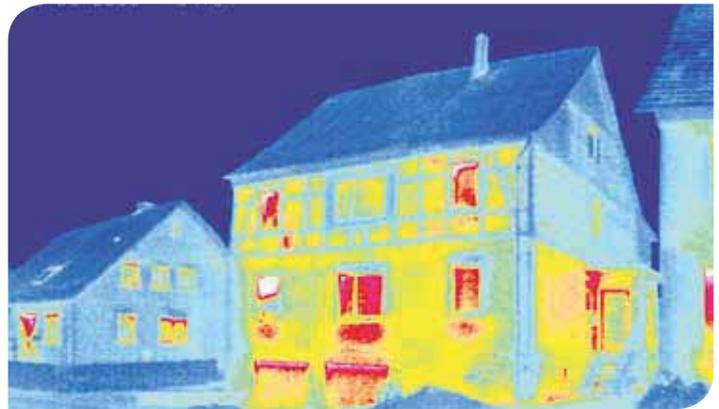
Dem Auge des Menschen überlegen: Wärmeabbildung mit Hilfe der Thermografie
