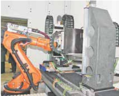
Weltneuheit in Fürth: Mit der neuen Röntgen-Technologie Dragonfly des Fraunhofer-Entwicklungszentrum EZRT kann die Prüfzeit von Gussteilen um die Hälfte reduziert werden.
