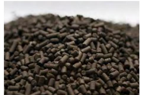
**Aktivkohlegranulat, das in einem Kohlebett zur Entfernung von Spurenstoffen aus dem Abwasser eingesetzt wird.**
