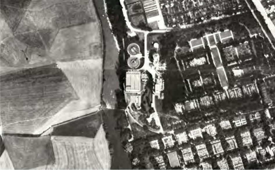
Insgesamt erstreckte sich die Hauptklär-anlage Fürth im Jahr 1966 nach wie vor auf eine Fläche von ca. 30.000 m<sup>2</sup>. Zu sehen sind noch die alten Schlammstapelbecken, auf deren Grundfläche dann 1972 die zweite Biologische Reinigungsstufe errichtet wurde.
