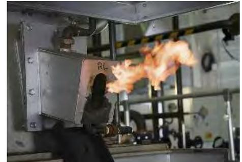
**Beim Anfeuern des Ofens strömt etwas Brenngas aus dem Schlackeloch.**
