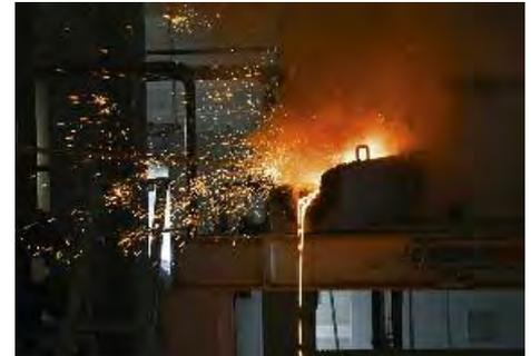
**In regelmäßigen Abständen wird am Boden des Ofens das Eisen abgestochen.**
