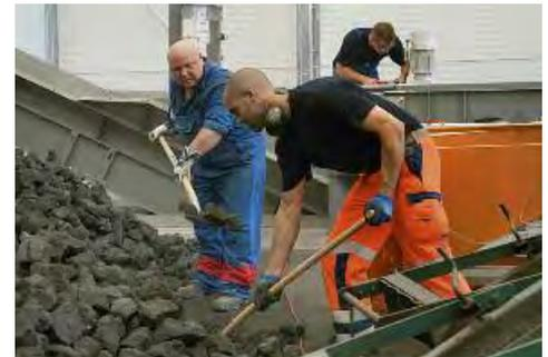
**Die Versuchsanlage bedeutet auch Handarbeit: Zwei Mitarbeiter beschicken das Förderband mit den aus getrocknetem Klärschlamm geformten Briketts.**
