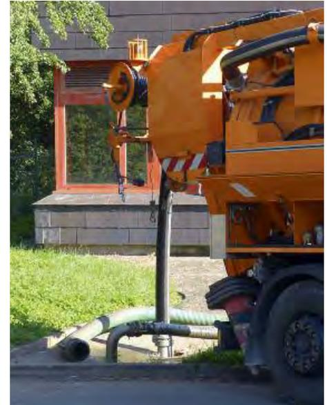
Das Bild zeigt die Anlieferung von Co-Substraten. Die Fettabseiderrückstände werden in Saugfahrzeugen gebracht, in einen Schlammschacht abgelassen und von dort direkt in die Faulbehälter gepumpt. Die Fette werden nahezu vollständig in Gas umgesetzt. Die verbleibenden Reststoffe können problemlos mit dem Klärschlamm entwässert und entsorgt werden.
