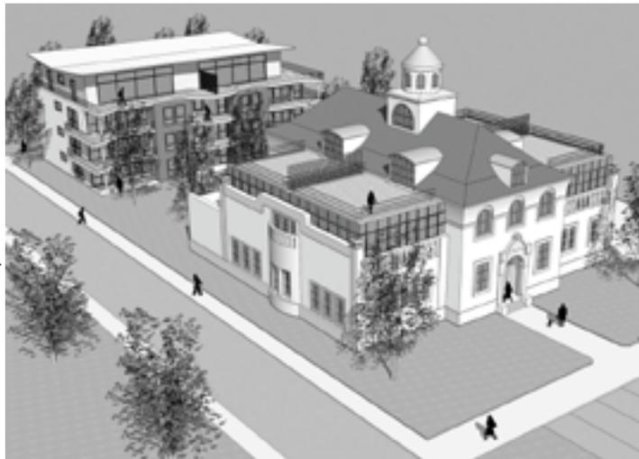
Planung für den Steubenpark: Das frühere Offiziers-Kasino mit Kuppel und Rundturm erhält an den Seitenflügeln Aufbauten aus Glas und Stahl und wird mit Dachterrassen versehen. Hinten: der Neubau mit elf Eigentumswohnungen.
